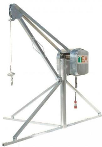
Строительная лебедка l'Europea HE525 MF итальянского производства оснащена уникальным запатентованным двигателем повышенной мощности — 2500 Вт, что позволяет ей с легкостью поднимать грузы до 500 кг на максимально возможную высоту — 60 метров (это 20 этажей!). Огромными преимуществами данной лебедки также являются:
