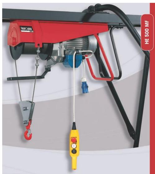
Консольно-балочный кран HE500 при помощи монофазного двигателя осуществляет подъем грузов со скоростью 22 м/мин. Максимальная высота подъема — 40 метров. Подойдет как для малоэтажного, так и для многоэтажного строительства. Для изготовления консоли используется высококачественная оцинкованная сталь. Время сборки — 30 минут. Небольшие размеры упрощают хранение и транспортировку. Благодаря 160 см ширине основания консоли возможна выгрузка материалов в полетах на перекрытие.
