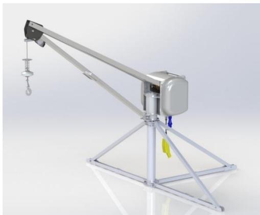
Строительная лебедка модели HE725 производства Италии имеет максимально возможную высоту подъема 60 метров равную 20 этажам здания. Благодаря двигателю повышенной мощности в 3000 Вт и высококачественным материалам данная лебедка обладает грузоподъемностью 700 кг и скоростью подъема – 22 м/мин!
